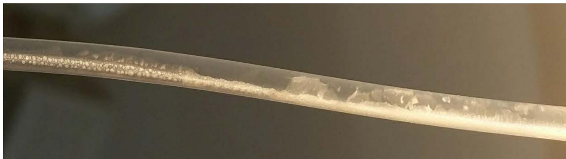
Dépôts de médicaments sur les parois d'une tubulure
