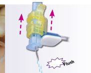
A l'aide du pouce faire descendre le piston en contact avec la peau et relever simultanément l'extracteur jusqu'à entendre un clic (verrouillage).
